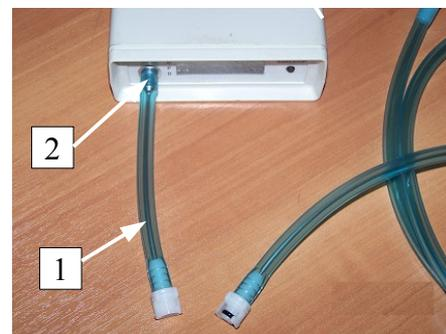
3. соедините короткую (1) и длинную (2) части пневмошланга при помощи разъемного штуцера (3). Для этого соедините две части разъемного штуцера и поверните их друг относительно друга до щелчка.
