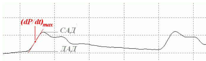
Рис. 13. Принцип измерения максимальной скорости нарастания давления.
